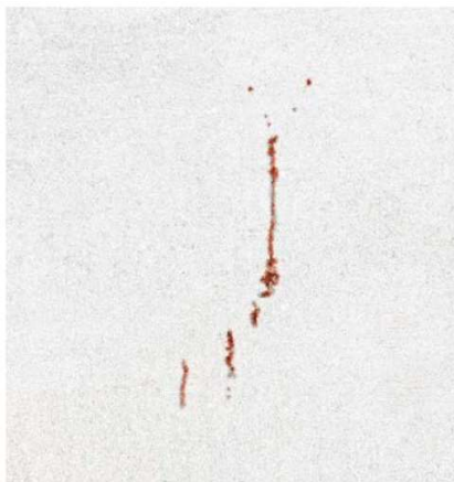
浸透探傷の検査画像（欠陥を赤色に可視化）
